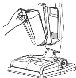
Plăcuța de identificare este situată în spațiile rezervorului de apă uzată. Rezervorul de apă uzată trebuie demontat pentru a se vedea informațiile de pe plăcuța de identificare.
