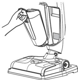
La plaque signalétique est située derrière le réservoir d'eau sale. Le réservoir d'eau sale doit être retiré pour qu'il soit possible de voir les informations sur la plaque signalétique.
