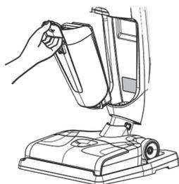
Tipska ploščica je na zadnji strani posode za umazano vodo. Posodo za umazano vodo morate odstraniti, da vidite informacije na tipski ploščici.
