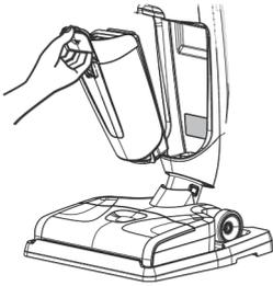
Das Typenschild befindet sich hinter dem Schmutzwasserbehälter. Es ist nur bei ausgebautem Schmutzwasserbehälter sichtbar.
